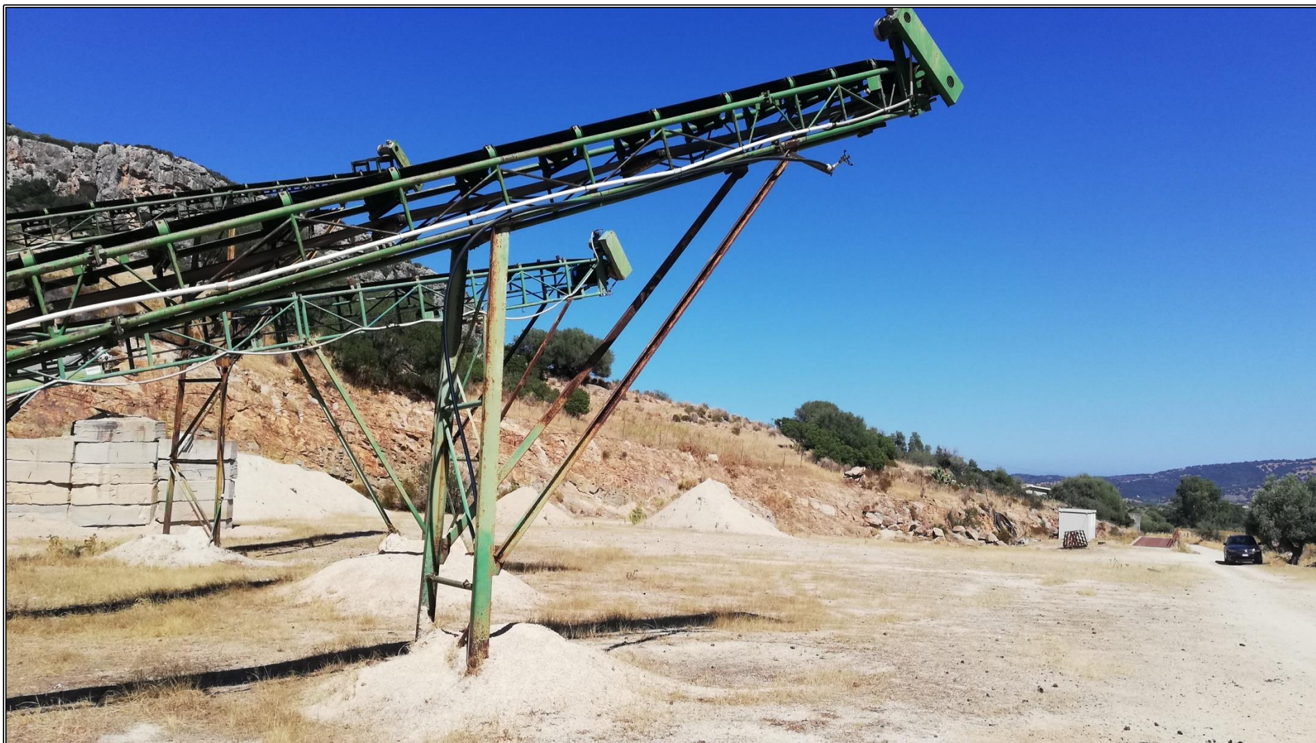
Foto n°39 – Nastri per l'accumulo del materiale con in evidenza gli spruzzatori per l'inumidimento del materiale per l'abbattimento delle polveri.
