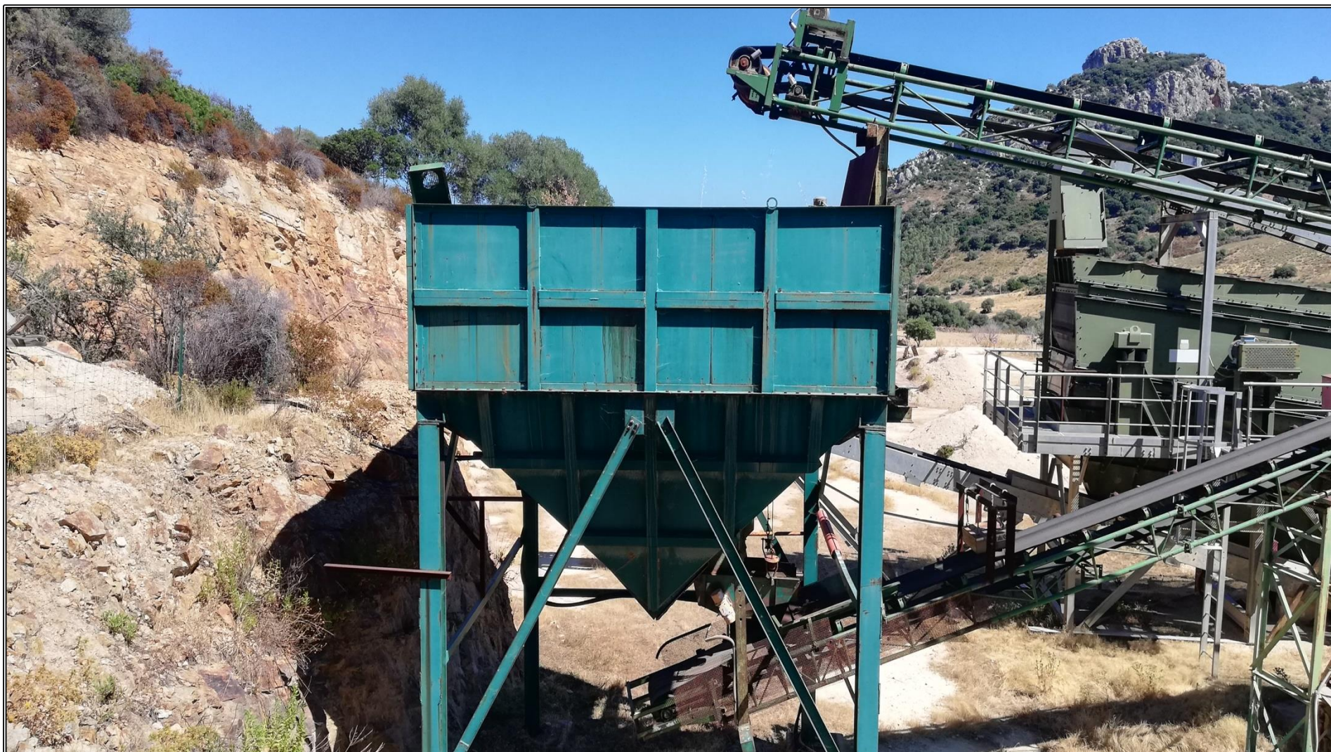
Foto n°33 – Silos di accumulo del materiale per invio all’Hydrocone .
