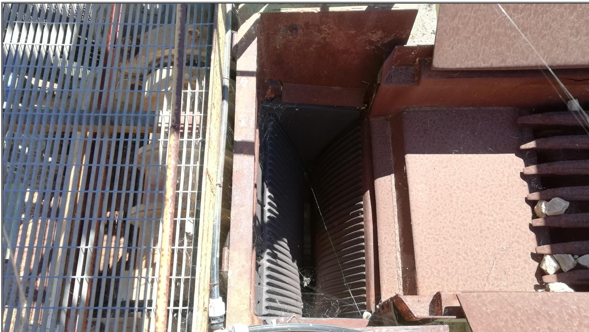
Foto n°30 – Dettaglio Frantoio con in primo piano il tubo per l'inumidimento del materiale per l'abbattimento delle polveri.
